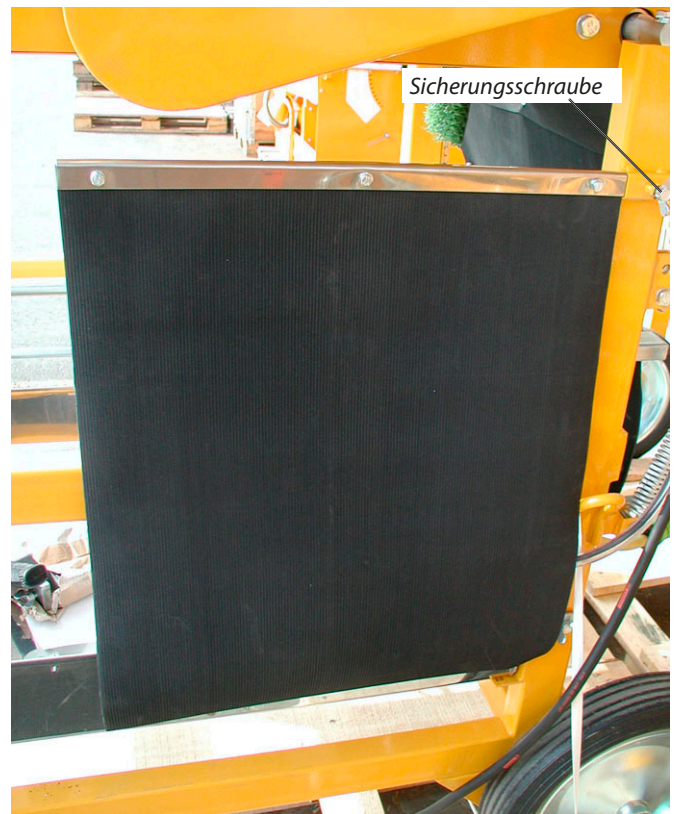
Schutzmatte (rechts) montiert
