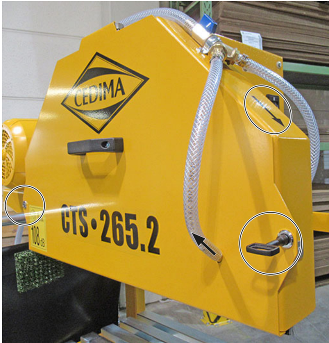
Den Wasserschlauch vom Blattschutz-Deckel ziehen, Verriegelungen am Blattschutz mit dem Vierkantschlüssel öffnen Bild 4.11
