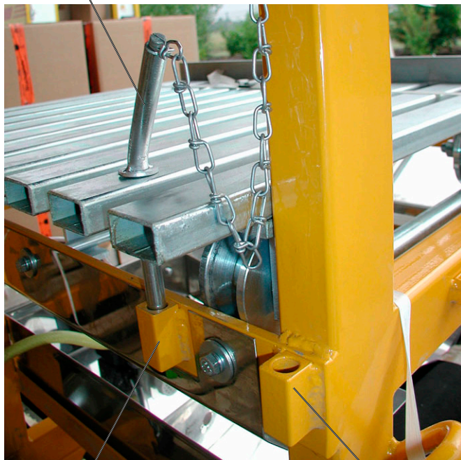
Transport-Aufnahme Rollentisch-Sicherungsbolzen in Transportposition Einsatz-Aufnahme Bild 4.5
